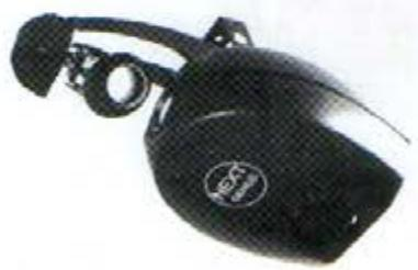
регулируемый эффект "радуги"; высокоскоростной строб (отдельная шторка), блэк-аут; электронный диммер (в галогеновой версии); улучшенное движение зеркала Pan 180 град. – Tilt 80 град., инверсия Pan-Tilt; угол раскрытия луча (стандартный 15 град. и дополнительно 20 град.); регулируемый фокус; 5 шаговых двигателей. Лампа: 24 В 250 Вт (300 ч) или HQIT150 (6000 ч). Напряжение питания 220/240 В 50 Гц или 120 В 60 Гц.
