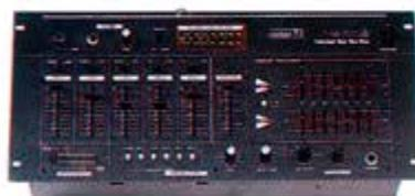
Пульт DM-602A питается от сети переменного тока с напряжением 110 В – 240 В, 50/60 Гц, потребляемая мощность – 9,8 Вт. Вес DM-602A равен 5 кг при габаритах 482 x 98 x 222 мм. Боковые панели имеют отверстия, позволяющие устанавливать пульт в эко-скую стойку.
