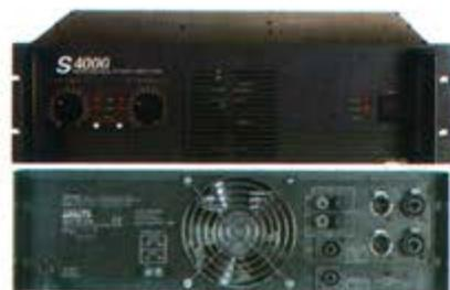
В целях демпфирования переходных процессов усилители оборудованы системой плавного включения питания. Охлаждение S-3000/4000 обеспечивается с помощью постоянно действующего вентилятора, врачающегося с переменной скоростью. В случае перегрева включается специальный контур защиты. Кроме того, усилители имеют защиту от внезапных токовых перегрузок, короткого замыкания, радиочастотного излучения, падения сопротивления нагрузки ниже 2 Ом, перегрузки по выходу и от постоянного напряжения.
