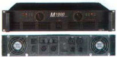
Для демпфирования переходных процессов усилители оборудованы системой плавного включения питания. Охлаждение обеспечивается с помощью постоянно действующего вентилятора, врачающегося с переменной скоростью. В случае перегрева включается специальный контур защиты. Кроме того, усилители имеют защиту от возникновения постоянного напряжения и падения сопротивления нагрузки.
