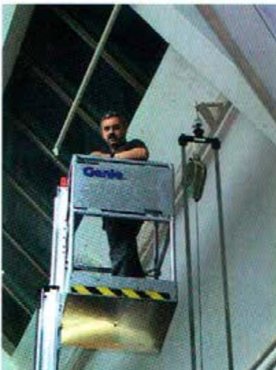
электропривод, 220 В), в верхней части которого находится "корзина" для одного человека. Лифты очень маневренны, в сложенном состоянии легко транспортируются через дверные проемы. В "Газодобытчике" один лифт был укомплектован основанием Super Staddle, позволяющим работать на наклонном полу или на лестнице с разностью высот между точками опоры до 1,2 метра. С таким основанием лифт можно установить посередине зала, занятого креслами для зрителей.
