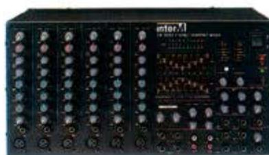
Мастер-секция пульта имеет: основной стереовыход; 9-полосный графический эквалайзер с крутизной подавления ±12 дБ и частотами 63 Гц, 125 Гц, 250 Гц, 500 Гц, 1 кГц, 2 кГц, 4 кГц, 8 кГц, и 16 кГц; 2 выхода посылов на эффекты; стереофонический вход возврата, 1 мониторный выход, а также входы/выходы Tape In/Tape Out для коммутации с магнитофоном.
