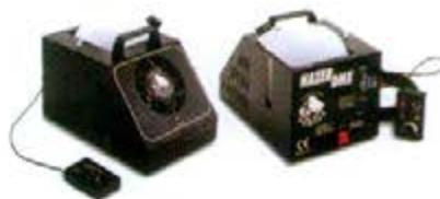
ного управления, который входит в комплект. Мощность – 1100 Вт, напряжение 220/240 В, 50 Гц. Габариты 310мм x 200 мм x 180 мм; вес 5 кг.
