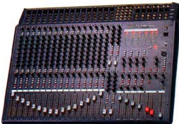
регуляторы дофейдерных посылов AUX 1/2 для каналов 1/3 и послефейдерных посылов AUX 3/4 для каналов 2/4, а также регулятор баланса и 45-миллиметровые фейдеры.
