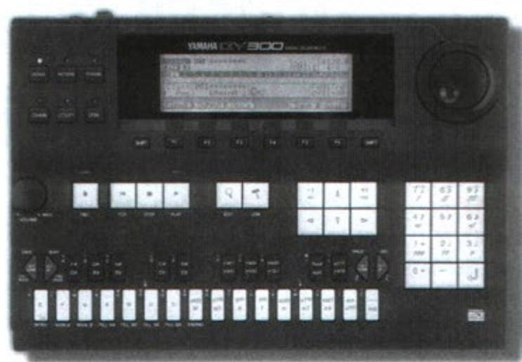
ценовой концепции разработчиков этой модели, синтезатор не имеет цифрового звукового выхода. Предусмотрены раздельные аналоговые выходы (левый/моно и правый), стереовыход для подключения наушников, а также три разъема для подключения педалей. Кроме того, инструмент оснащен полным набором MIDI-разъемов (In, Out, Thru).
