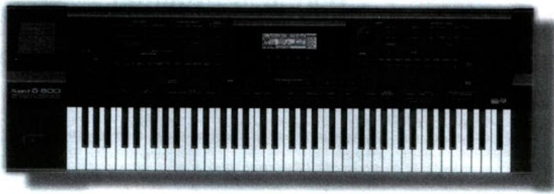
этой модели нового, более точно го регулятора Pitch bend/Modulation. Во-вторых, заслуживает внимания режим Piano Style Mode, в котором аккорды распознаются не только в басовой части клавиатуры, но по всему диапазону фортепианных клавиш. Таким образом, автоаккомпанемент управляет в реальном времени с использованием всего диапазона 76-клавишного инструмента.
